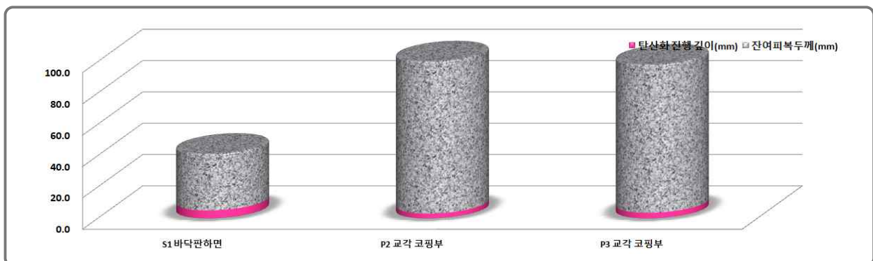
[그림 10.3.5] 탄산화깊이 및 잔여피복두께 측정결과
